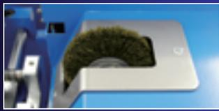
⑤ シリンダー、ミーリング部の切粉飛散防止用スイング式兼用カバー!
